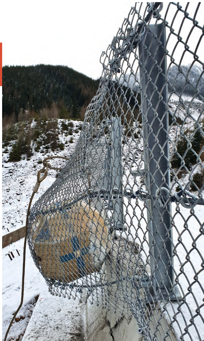
Foto 9: Testversuch in den Netzverbau mit 107 kJ
