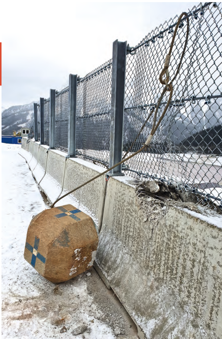
Foto 8: Testversuch in die Betonleitwand mit 114 kJ
